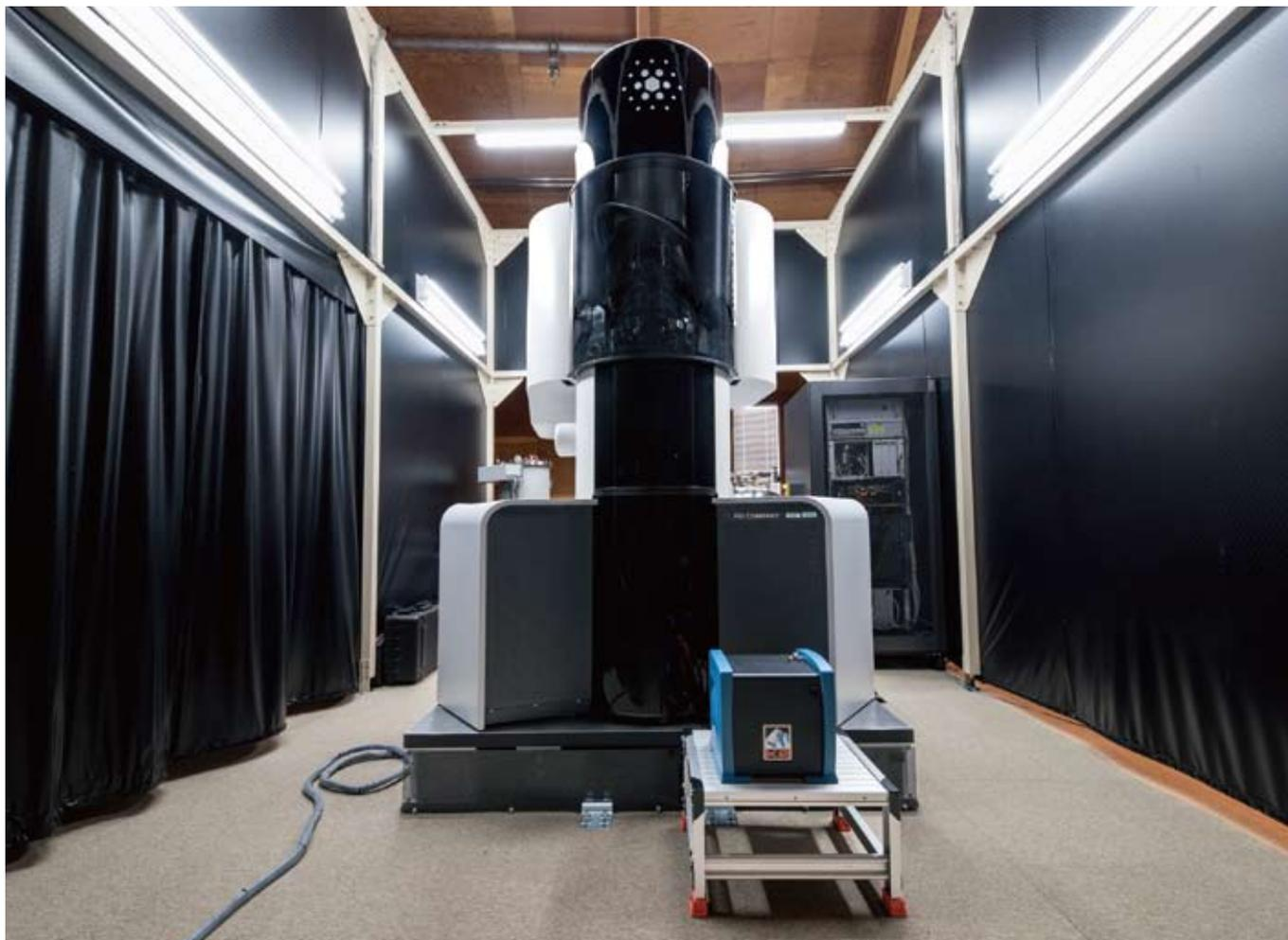
▲ 高さは約3m。電子をカウントする最先端の検出器を搭載し、その情報を手前の箱で処理します。ここでは3台の透過型電子顕微鏡が稼働しています。
