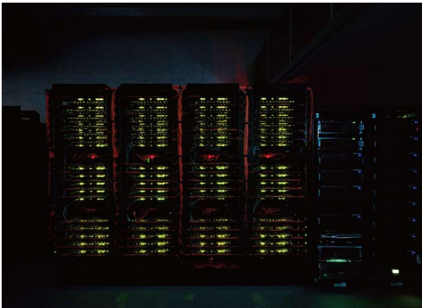
▲ 新開発のLSIを8個搭載した基板を64枚連結し、システム全体として約1.3ペタフロップス(1秒間に1,300兆回)の計算能力を持ちます。
