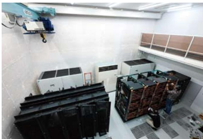
▲ MDGRAPEは、天文学での重力多体問題専用計算機GRAPE (GRAvity PipE、重カパイプライン) の、分子動力学 (Molecular Dynamics) バージョン。今回はその5作目。
