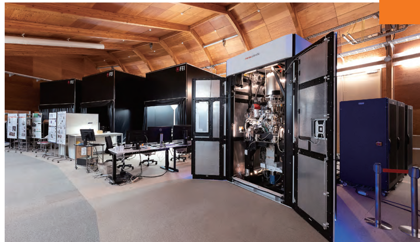
▲ 3台のクライオ電子顕微鏡が立ち並ぶ中央NMR棟。右端は、加速電圧300kVの電子銃を備えた最新鋭のクライオ電子顕微鏡(エンクロージャーの扉を開けたところ)。左隣は解析用PCと試料調製スペース。奥の2室には200kVクライオ電子顕微鏡が入る。
