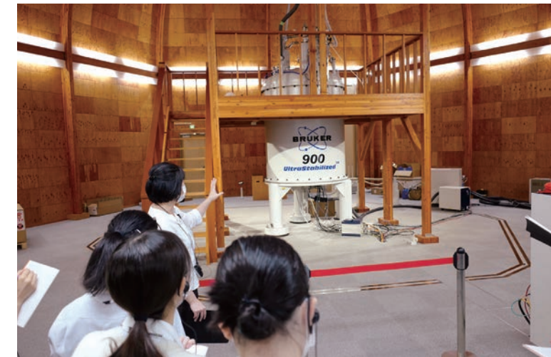
▼ 900MHz NMR装置に組まれた木製の矢倉には、釘を使わない宮大工の技が活かされている。先端機器と伝統技術の組み合わせに、見学に来た高校生も興味津々。
