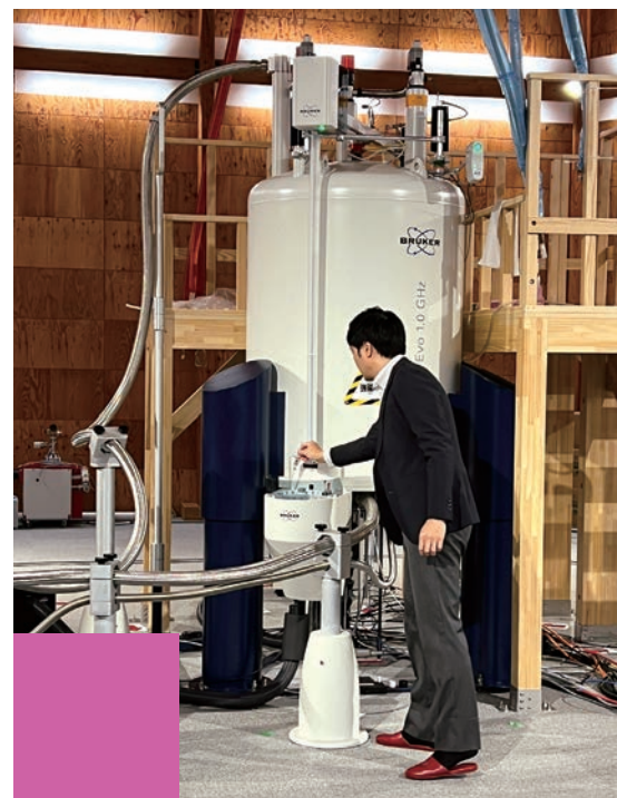
◀ 1GHz NMR装置に測定試料をセットする様子。試料管は気圧式輸送チューブで装置の上部に運ばれ、自動でマグネット内部に装填される。
